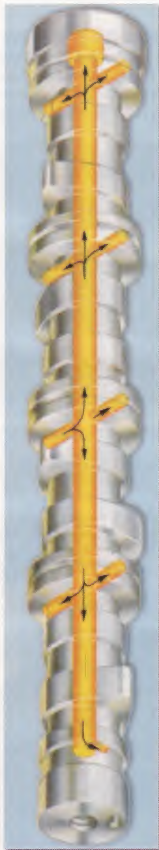
Conductos de lubricación del árbol de levas policilíndrico
